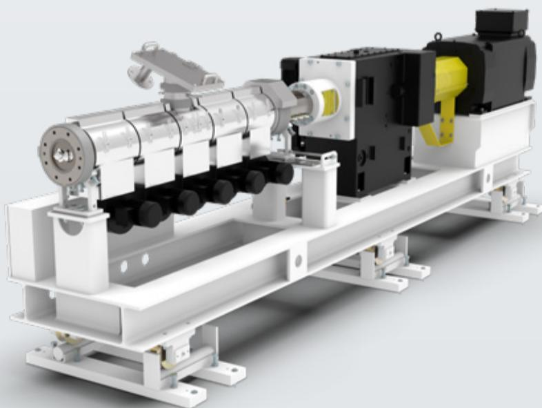
螺杆，可方便快速、轻松地更换螺杆。通过陶瓷加热器和风冷控制机筒温度，这是一种精准、低本高效且低维护的解决方案。SML 提供不同长度的预配置一体式机筒设计，可根据不同应用提供通风端口。在挤出机螺杆方面，则可选择一体式解决方案或带分段式螺杆元件的轴体。
