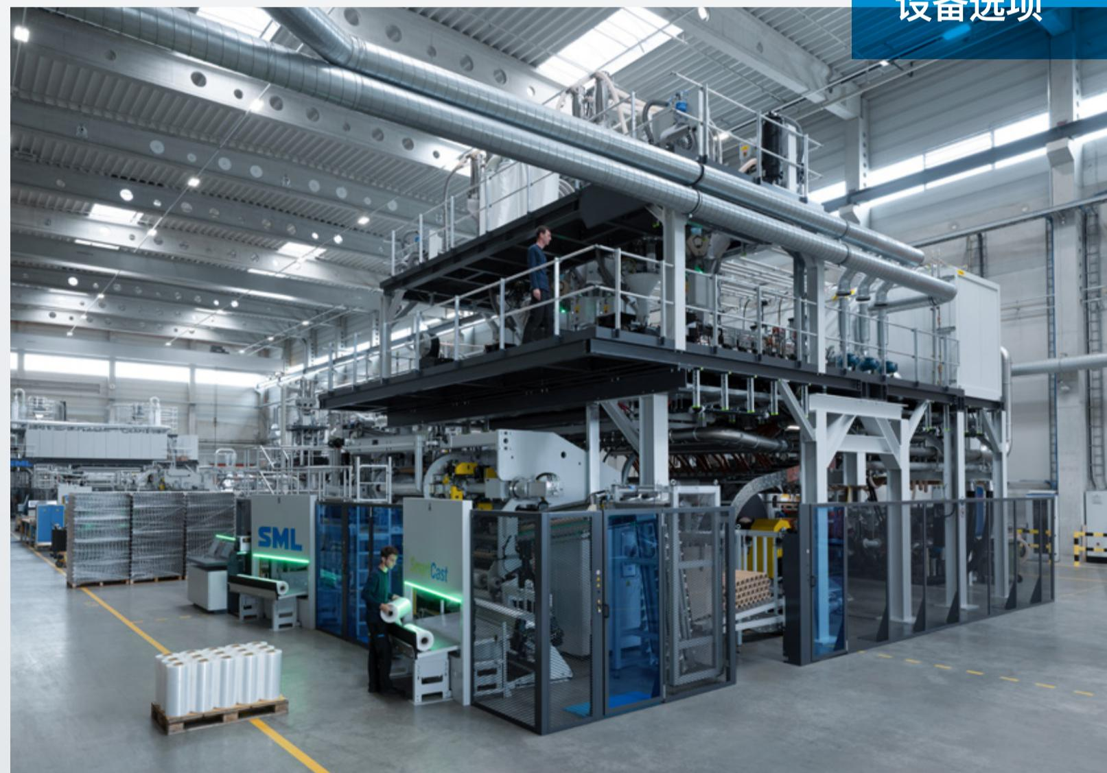
SmartCast 拉伸薄膜生产线 (6-up) 是 SML 产品组合中功能最为多样化的拉伸薄膜生产线之一。其设计特点是可提供广泛多样且功能强大的高效拉伸薄膜生产设备选项，产品涵盖 2 英寸手工膜卷、高品质机用膜卷、60 kg 超大型膜卷以及折边薄膜等。SML 在 K 展会上推出新一代 SmartCast 品牌，并展示其在生产线设计和产品质量方面的创新成果。
