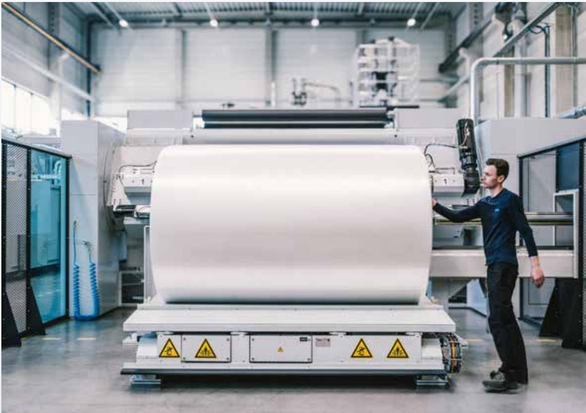
气量和调节膜卷硬度。收卷机既可以有轴操作也可无轴收卷。在收卷机的入口段为安装后冷却预留了空间。
