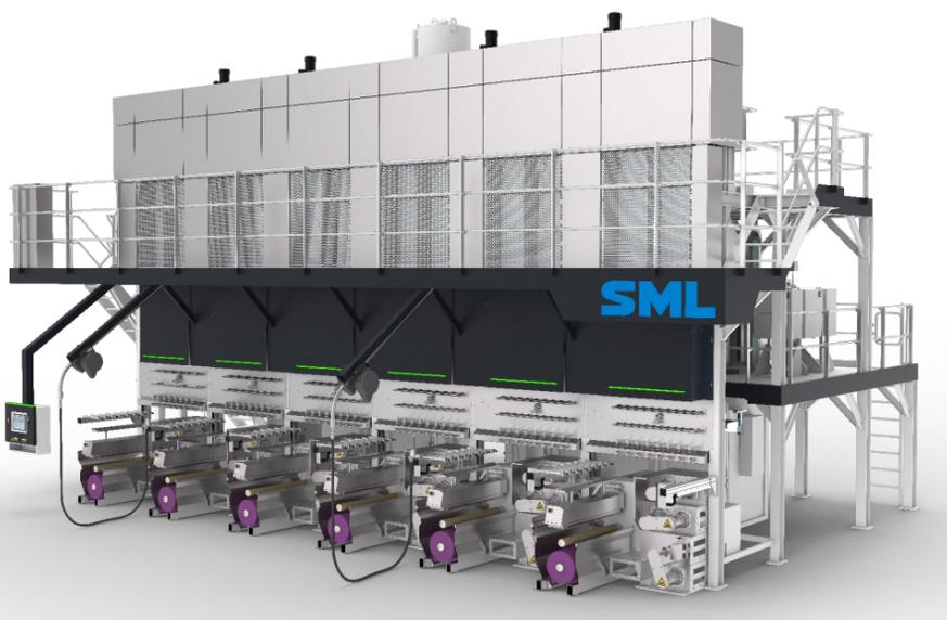
MT/HT 4x4. Кроме того, концепция "line-by-line" дает возможность конфигурации мощностей линии простым добавлением дополнительных прядильных узлов. Это выполняется благодаря особой стальной конструкции, позволяющей легко встраивать в линию дополнительные узлы.
