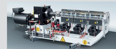
Экструдеры HO-LT SML (High Output – Low Temperature/Высокая производительность-Низкая Температура) отлично подходят для работы с чувствительными к термообработке полимерами, и обеспечивают энергоэффективность и превосходное качество расплава. Данные экструдеры были представлены в 2011 году и в дальнейшем непрерывно модифицировались, на сегодня они перерабатывают широкий диапазон различного сырья, включая очень прозрачные полимеры, такие как PMMA и материалы, содержащие галоген.
