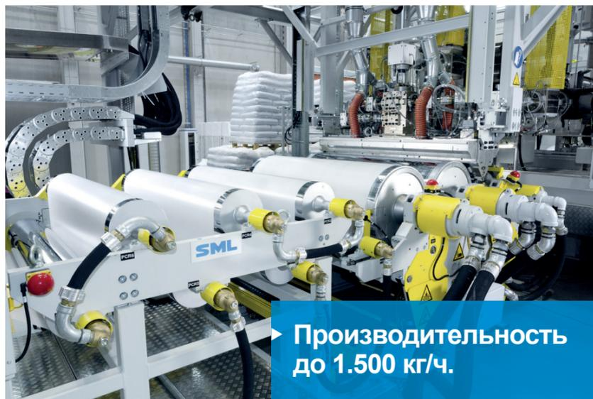
SML представляет новую высокопроизводительную экструзионную линию для производства высококачественного листа из полистирола, материала для последующего изготовления FFS упаковки. Новая линия с производительностью до 1.500 кг/ч. была сконструирована для известных во всем мире компаний, которые выпускают молочную продукцию и кондитерские изделия в больших объемах.
