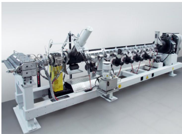
HSE экструзионная система для линий с вертикальным каландровым узлом
