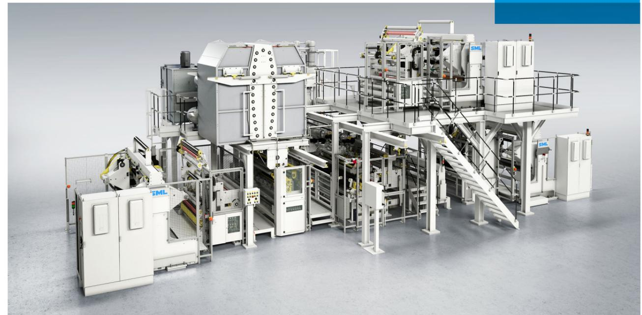
尽管易于回收的单一材质塑料包装可能比纸张或纸板塑料复合材料更环保，但开发以纸张为基材的复合结构材料仍是一个明显的市场趋势。能够在基材上涂覆超薄聚合物涂覆层对于环保型复合包装材料的生产至关重要。SML的挤出涂覆生产线凭借其极为优异的熔体质量在超薄涂覆市场享有盛誉。
