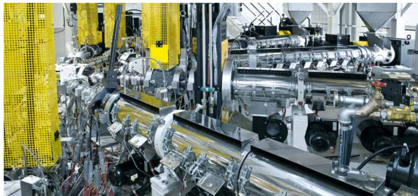
EXTRUDER ARRANGEMENT OF A BARRIER SHEET LINE ▲
